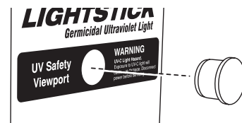
Fig. 14. Appuyez sur le hublot pour le mettre en place.
