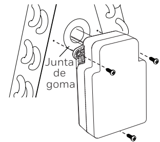
Fig. 8. Inserte el ensamble en el agujero ciego de la placa delta y fíjelo con tornillos.
